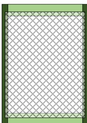
An den Stellen, an denen das Streckgitter aufliegt, vor der Montage mit dem Hobel 2 mm abhobeln.
